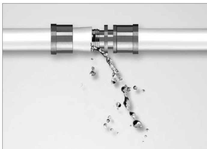
Kontrola wzrokowa niezaciśniętego połączenia aksjalnego
