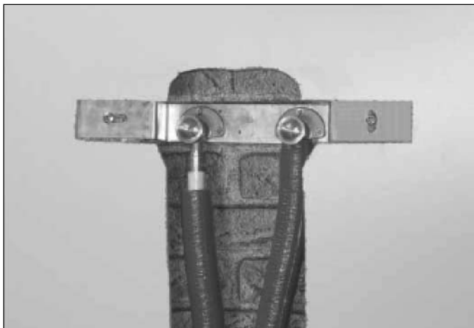
Podejście dopływowe do baterii z kolanami naściennymi Ø 17(16) mm x 1/2" GW
