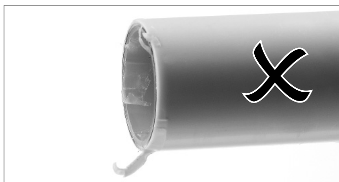
Nieprawidłowo skalibrowana i sfazowana rura
